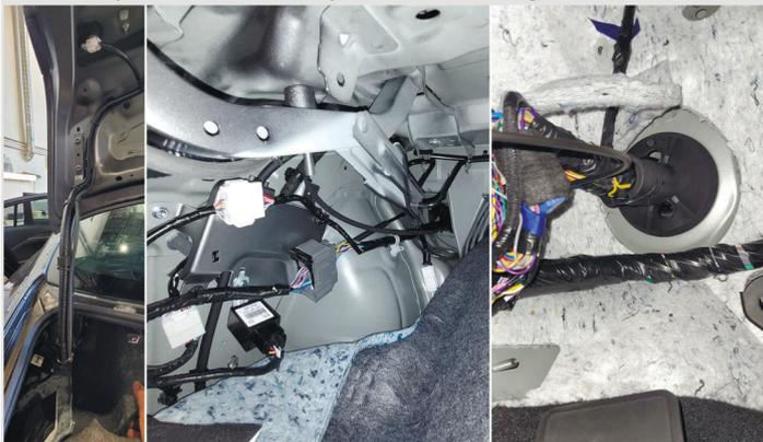
**11** Снимите **5 клипс** и приподнимите **пластиковую накладку** рамы лобового стекла. Проложите **шланг** как показано на рисунке.
