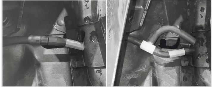
**13** Включите омыватель заднего стекла, убедитесь в отсутствии течей. Сборка авто осуществляется в обратной последовательности. Убедитесь, что наклейки не пережимают шланг подачи жидкости к омывателю камеры). Отрегулируйте форсунку так, чтобы струя разбивалась о ближний к ней край объектива (место указано красной стрелкой).
