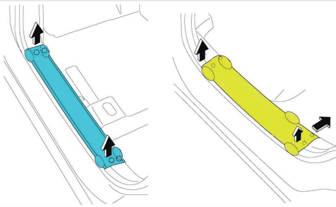
**8** Снимите **накладку кик - панели** и облицовочную накладку средней стойки кузова.
