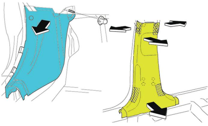
**9** Выверните болт и снимите боковую спинку заднего сиденья, потянув ее вверх. Снимите **3 клипсы** и отогните **верхнюю часть** левой обивки багажного отделения.
