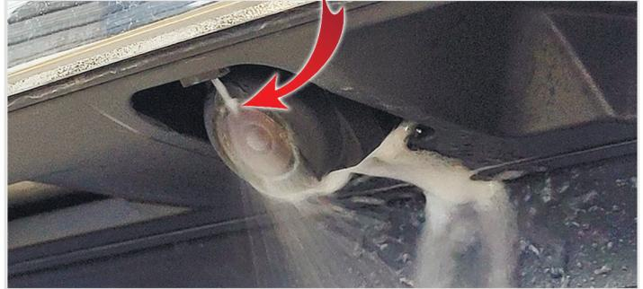
**14** Для регулировки форсунки используйте кнопку - гвоздь (в комплекте), согнув её плоскогубцами, как это показано на рисунке.
